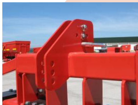
Cabeçote do Geo-combie preparado para trabalhar com grade rotativa
