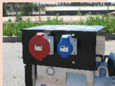
Tomadas monofásicas e trifásicas
