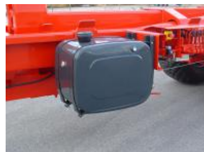
Tanque de óleo reforçado (120 lt)
